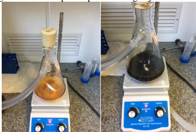
Figura 1: Antes e após do processo de gotejamento da base.
