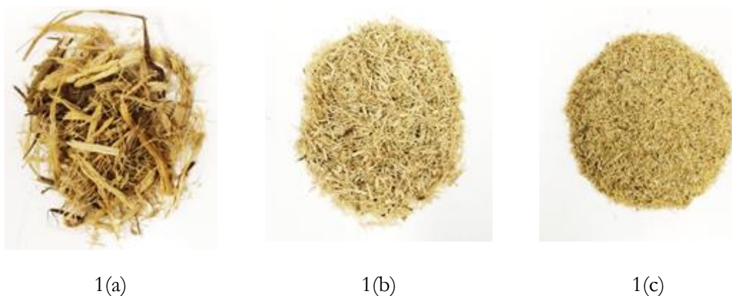
Figura 1 - Bagaço de cana-de-açúcar em diversas granulometrias. (a) in natura; (b) 20 mesh; (c) 40 mesh.
