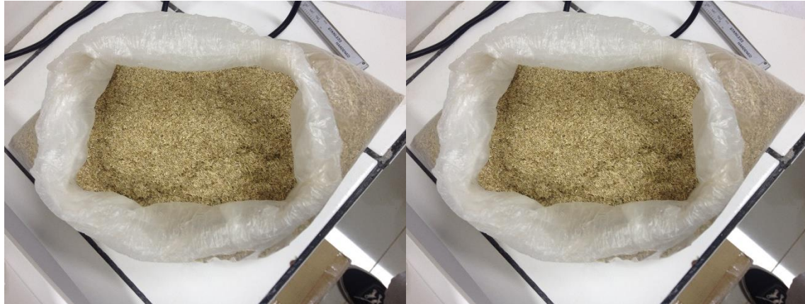
Figura 2 – (a) Mistura de palha e bagaço 40 mesh. (b) Mistura de palha e bagaço 20 mesh.
