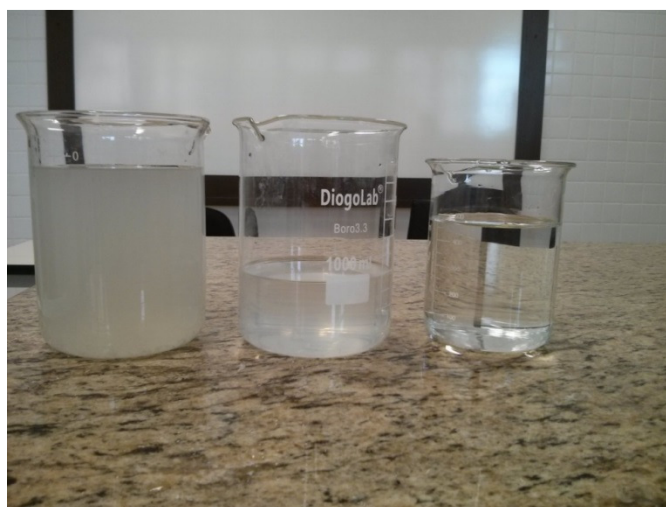
Figura 04: Béquer 1 - efluente bruto, béquer 2 - efluente do tratamento intermediário, béquer 3 - efluente do tratamento final.
