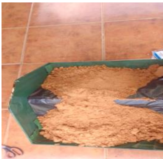
Figura 4 – Camada de drenagem
