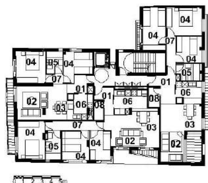
Fig. 10. Piso 3º Habitação de Proteción Oficial Cambó 2, Barcelona, (Espanha): Apartamentos com cozinha americana. Legenda: 1: hall, 2: sala, 3: sala de jantar, 4: dormitório, 5: banheiro, 6: cozinha, 7: corredor, 8: depósito.
