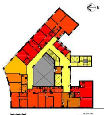
Fig. 11. Edifício São Paulo (São Paulo): orientação das janelas das unidades de habitação social.
