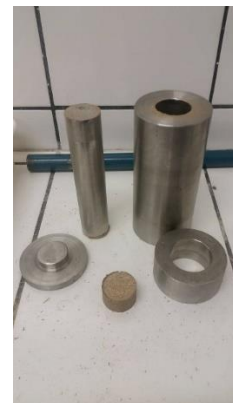
Figura 3 - (a): Prensa utilizada para confecção dos briquetes. (b): visualiza-se o briquete produzido. (c): Molde cilíndrico. Fonte: Marcos Paulo Granado
