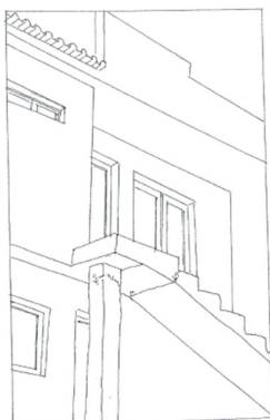
Figura 14: Deficiências de betonagem do topo das lajes
