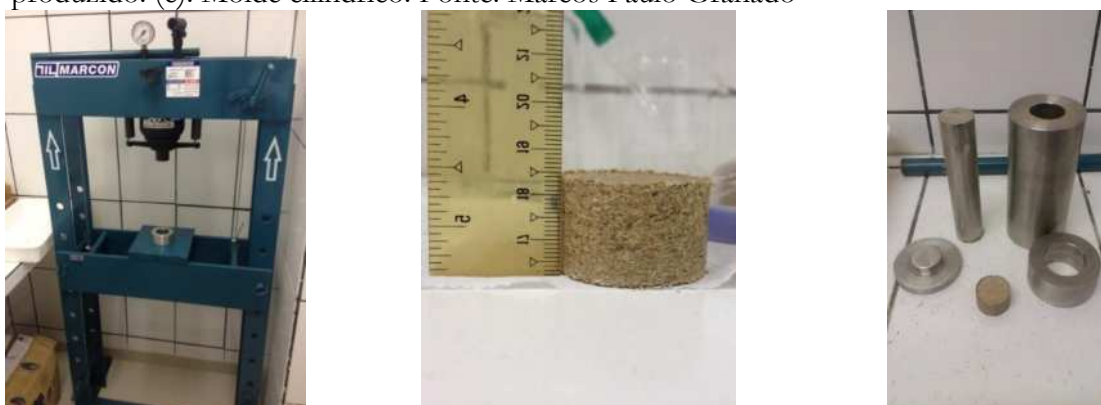
Figura 3 - (a): Prensa utilizada para confecção dos briquetes. (b): visualiza-se o briquete produzido. (c): Molde cilíndrico. Fonte: Marcos Paulo Granado
